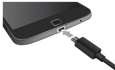
**请注意：**您的手机配备了充电速度最快的 TurboPower™ USB-C 3A-兼容充电器。使用其它带 USB-C 连接器的充电器可能会减慢充电速度，因此不推荐使用。不兼容的 USB-B (micro USB) 充电器和未经认证的适配器和数据线可能会损坏手机，请尽量避免使用。
